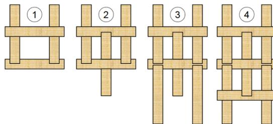
Um die Brücke weiter auszubauen, hebt man den gebauten Teil der Brücke an und beginnt nun wieder bei Schritt 1. Durch das Hinzufügen von 5 weiteren Holzstäben wird die Spannweite der Brücke vergrößert.
